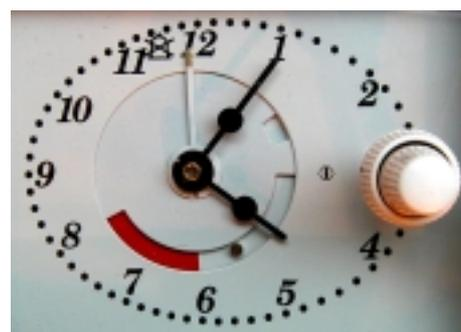
Dès que la zone rouge a disparu, 0 apparaît dans la lucarne **E** et le four s'éteint. Pour pouvoir le rallumer tourner le bouton **A** dans le sens horaire jusqu'à ce que le symbole "manuel" apparaisse dans la lucarne **E**. (voir paragraphe fonctionnement sans programmation).
